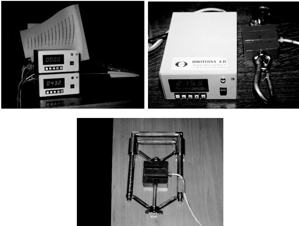
Slika 1. Tenziometrijska sonda sa digitalnim pokazivačem sile i konstrukcijom za procenu sile stiska šake
