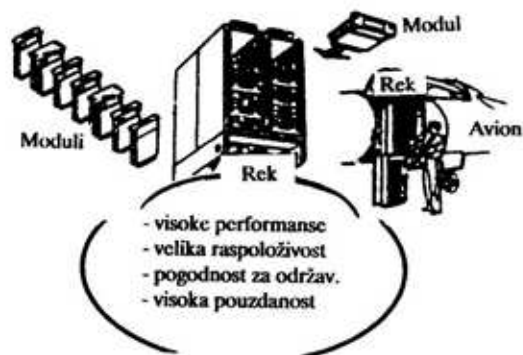
Sl. 2 – Izgled avionskog reka i prednosti savremenih fizičkih arhitektura aviona
