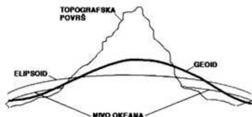
Sl. 1 – Odnosi između elipsoida, geoida i stvarnog oblika zemlje
