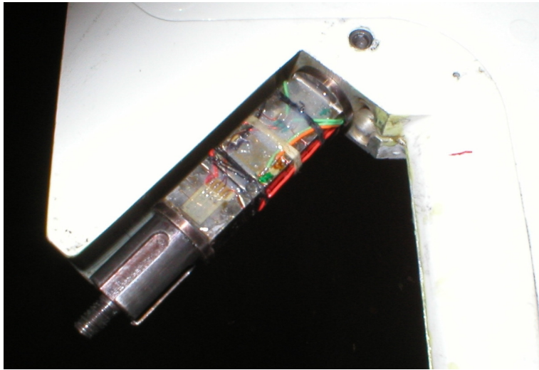
Sl. 7 – Trokomponentna aerovaga
