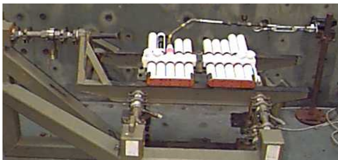
Sl. 1 – Ispitivanje raketnog motora na višekomponentnom opitnom stolu
