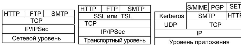
Рисунок 10 – размещение средств защиты в стеке протоколов TCP/IP
