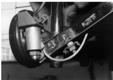
Slika 6 – Ugradnja davača kočnog momenta na doboš kočnici ispitivanog vozila Picture 6 – Mounting of the drum brake's brake torque sensor on the test vehicle
