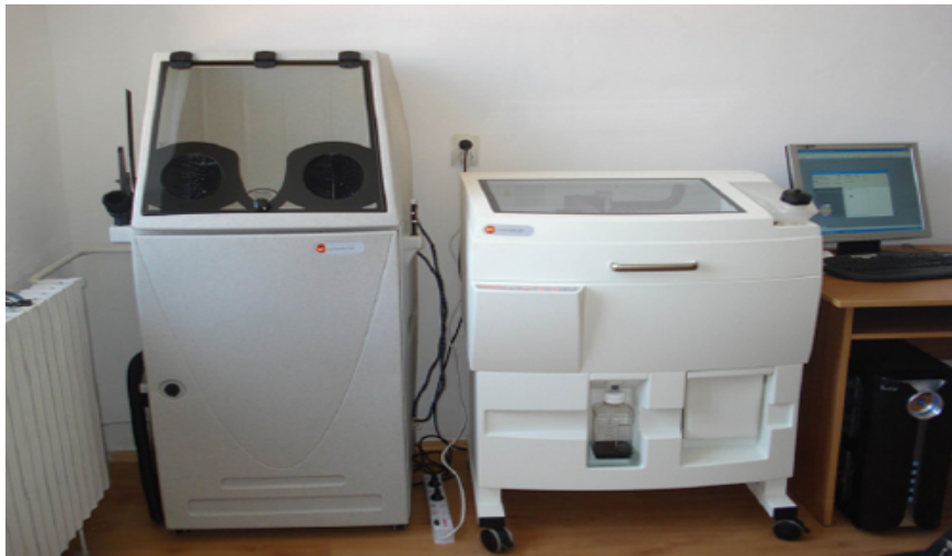
Slika 5 – Sistem za vođenje i štampanje Rapid Prototyping 3D Zcorp 310 Figure 5 – Rapid Prototyping 3D Zcorp 310 system for managing i printing
