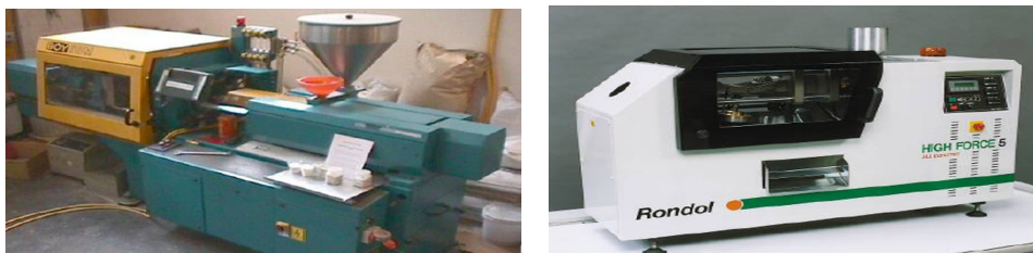
Slika 8 – Injekcijsko brizganje (gore), injekcijsko brizganje test-uzoraka za ispitivanje mehaničkih svojstava (dole) Figure 8 – Injection molding (above), injection molding test specimens for testing mechanical properties (below)
