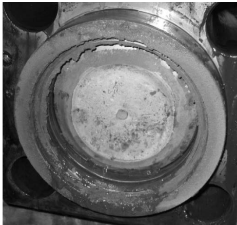
Figure 9 – The assembly of the housing and the piston of the hammer with solid particles Slika 9 – Sklop kućišta i klipa hidrauličnog čekića sa vidljivim čvrstim česticama
