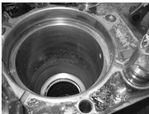
Figure 7 – Housing of the hammer with particles Slika 7 – Kućište čekića sa vidljivim čvrstim česticama
