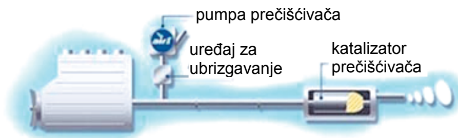
Slika 7 – Izgled prečišćivača sa delovima Figure 7 – Engine filter with parts
