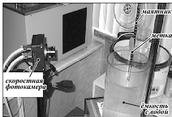
Рис. 6. Фотография установки для исследования затухающих колебаний физического маятника
