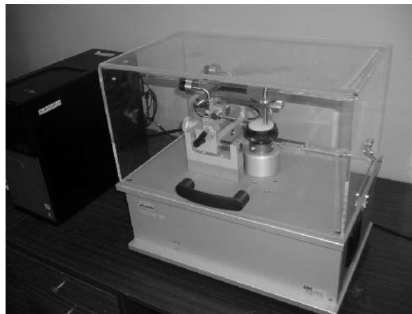
Рис. 2. Внешний вид трибометра TRB-S-DE, CSM Instruments
