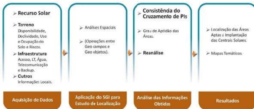
Figura 4 - Fluxograma de procedimentos para a identificação dos locais mais favoráveis para a instalação de centrais elétricas solares de grande porte. Fonte: CEMIG - Altas Solarimétrico de Minas Gerais, 2012.
