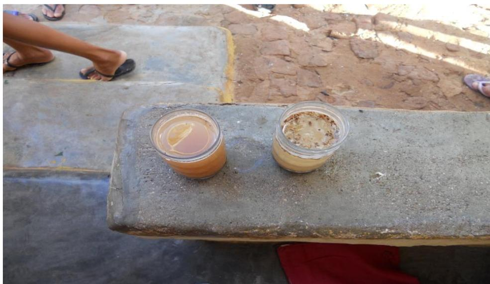
**Figura 5.** Amostra sendo sedimentada pelo uso de sementes de moringa, 2013.
