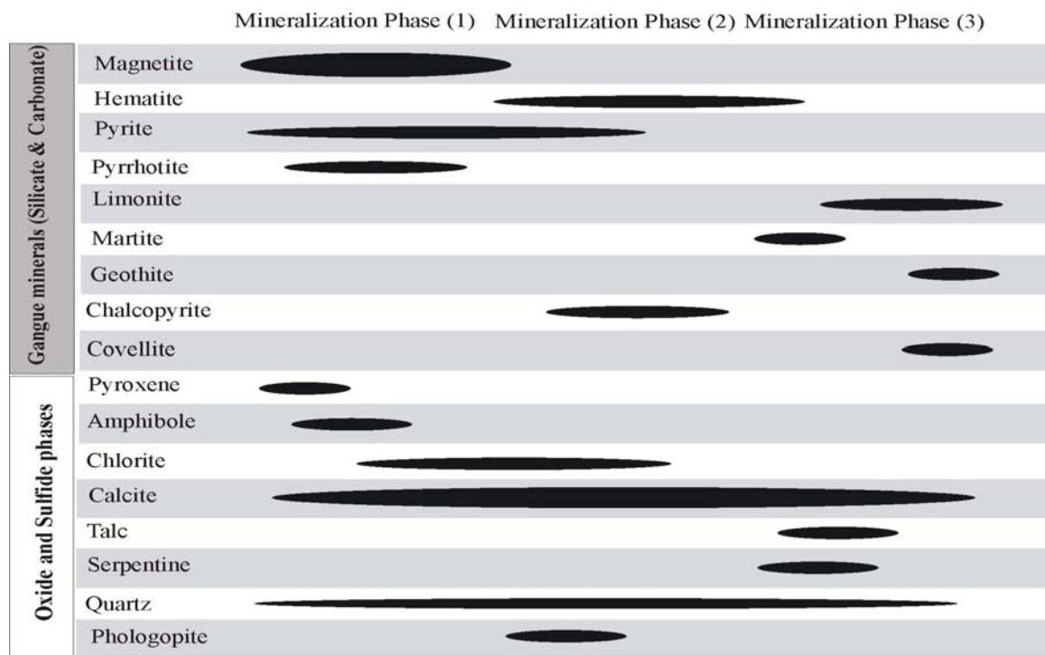
شکل ۸. توالی پاراژنزی کانیهای اکسیدی و سولفیدی اولیه، ثانویه و کانیهای باطله سیلیکاته و کربناته در کانسار آهن کورکورا-۱
