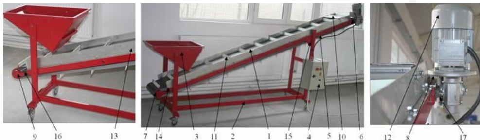
Fig. 4 – Belt conveyer TB-240 / Transportor cu bandă TB - 240
