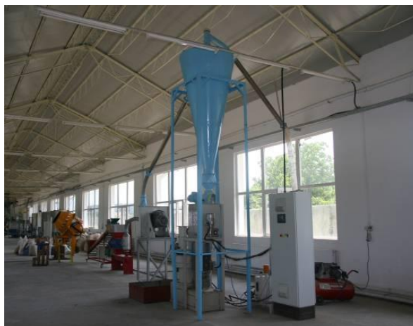
Fig. 6 – Integrated technological line of obtaining pellets and agripellets / Linie tehnologică integrată de obținere pelete și agripelete
