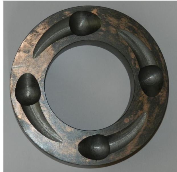
Fig. 2 - The constructive scheme (a) and the general form (b) of the working surface of the driving half-clutch of a safety device / Конструктивна схема (а) та загальний вигляд (б) робочій поверхні ведучої півмуфти запобіжного пристрою
