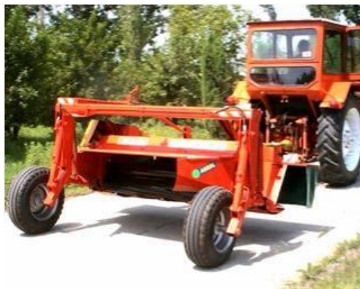
Fig. 1 - The windrover VTR - 2.4 în agregat cu tractorul U650 / Vindroverul VTR – 2.4 în agregat cu tractorul U650
