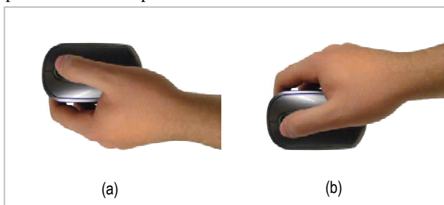
Figura 7. Poziții opuse în care dispozitivul R^3 poate fi ținut. În cazul mai sus prezentat, poziția aparatului este lateral-verticală: (a) prezintă o poziție cu stres ridicat pentru mâna utilizatorului, în timp ce (b) prezintă o poziție relativ relaxată.
