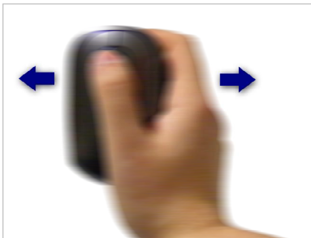
Figura 4. Scuturarea dispozitivului de-a lungul uneia dintre axe este interpretată de software-ul R^3 . În funcție de program și de preferințele utilizatorului, aceasta poate avea următoarele semnificații: comutare de mod, executarea unei comenzi prestabilite și altele.
