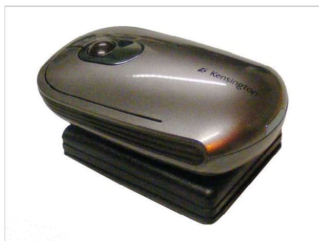
Figura 1. R^3 este compus dintr-un mouse cu funcțiile de rostogolire (roll), rotire (rotate) și scuturare (rattle) – în partea de sus – și un accelerometru cu trei axe – în partea de jos – în scopul creării unui dispozitiv cu 6 grade de libertate pentru interacțiunea în spațiu. Asamblarea și dezasamblarea reprezintă un proces aproape instantaneu, care să permită o conversie rapidă într-un mouse standard și înapoi.
