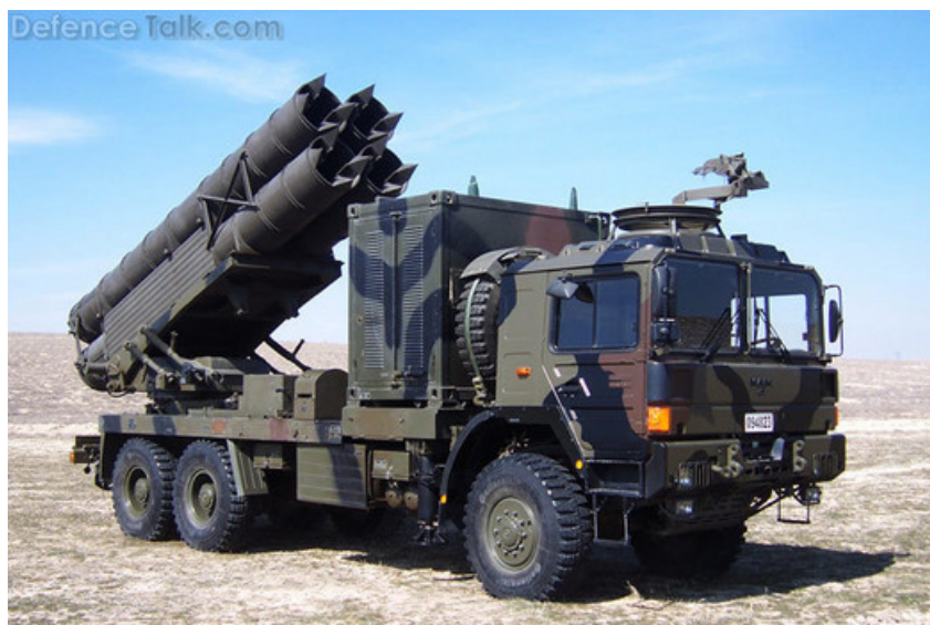
T-300 VRL turske kompanije Roketsan ispaljuje rakete 300 mm sa maksimalnim dometom do 100 km.
