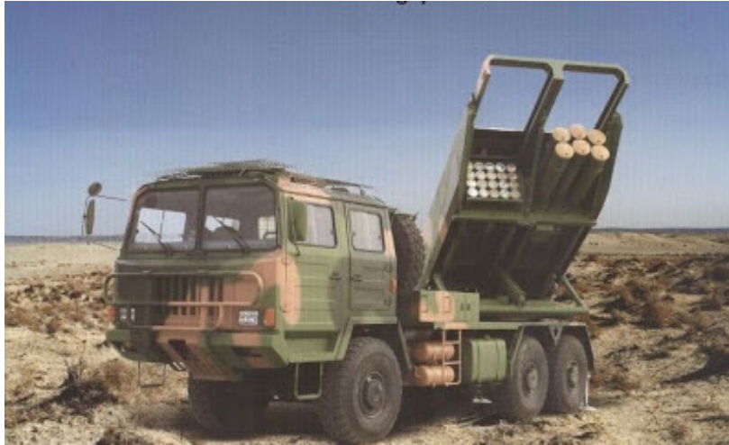
NORINCO SR5 zasnovan na šasiji/podvožju 6X6 sa lanserom raketa od 122 mm i od 220 mm
