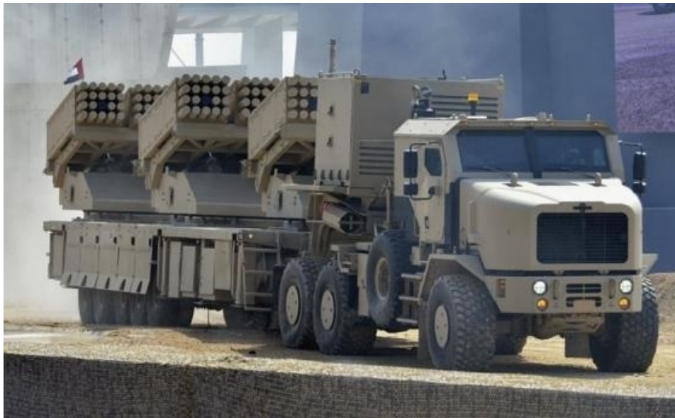
Multi Cradle Launcher/višestruki lanser sa kolevki u putnoj konfiguraciji sa prikolicom na kojoj se nalaze tri umesto četiri raketna kontejnera sa po 60 raketa od 122 mm.
