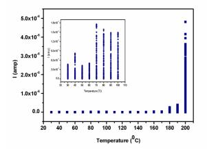
Fig. 11.TEMPERATURE DEPENDENCE CURRENT VARIATION OF Cu20(In14Ga9)Se45Te12 THIN FILM UNDER APPLIED VOLTAGE RANGE UPTO 40V
