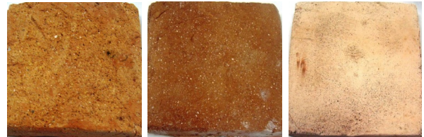
Şamotlu Çamur Kırmızı Çamur Akçini Çamuru Şekil 5: %35 Kum taşı katkılı agrega bünyeler (%35 Sandstone usage to form an aggregate body)
