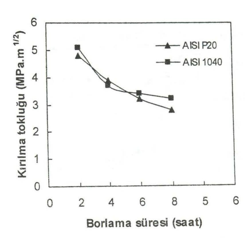
Şekil 9. Kırılma tokluğu grafiği
