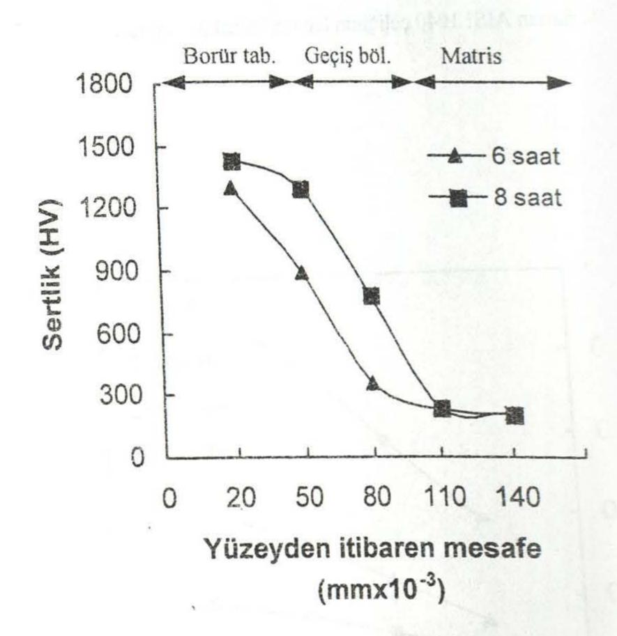
Şekil 5. 875 °C de borlanan AISI 1040 çeliğinde sertlik dağılımı
