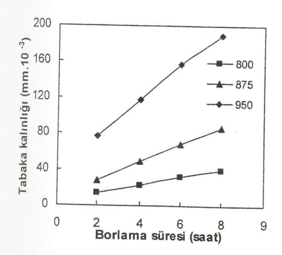
Şekil 3. Borlanan AISI P20 çeliğinin tabaka kalınlığı dağılımı
