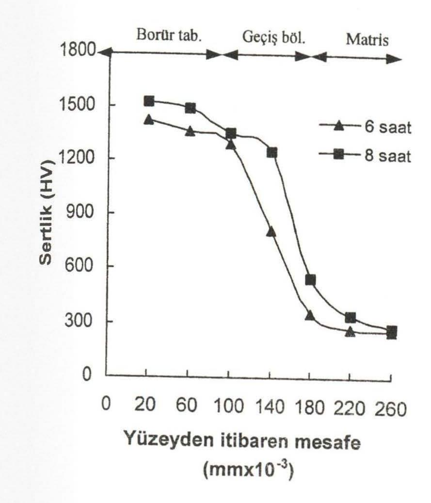
Şekil 6. 950 °C de borlanan AISI 1040 çeliğinde sertlik dağılımı.
