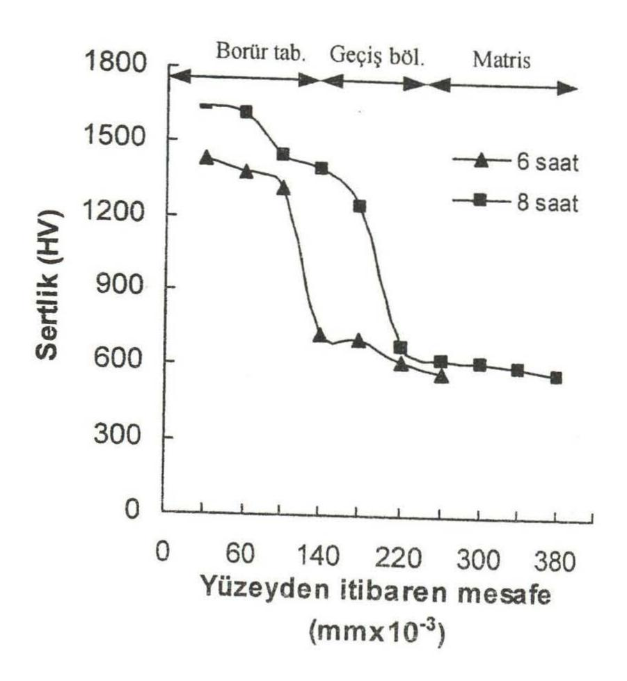
Şekil 8. 950 °C de borlanan AISIP20 çeliğinde sertlik dağılımı
