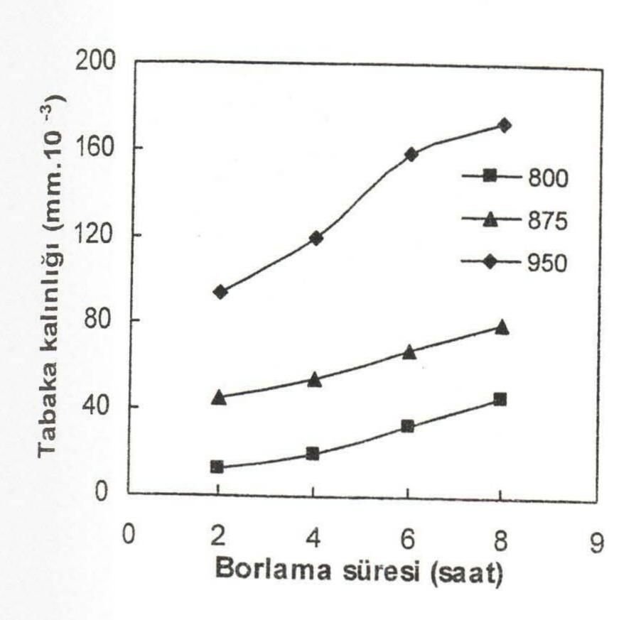
Şekil 2. Borlanan AISI 1040 çeliğinin tabaka kalınlığı dağılımı
