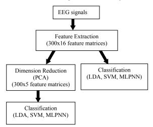
Figure 1. Block scheme of process (sürecin blok şeması)
