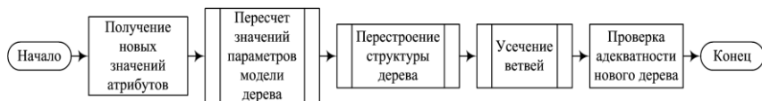
Рис. 2. Алгоритм дообучения и перестройки адаптивного нечеткого дерева принятия решений с динамической структурой
