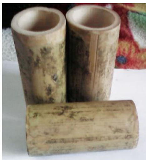
Figura 6. Probetas de GAK para ensayo a compresión.
