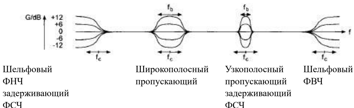
Рисунок 1. Частотные характеристики фильтров, применяемых в аудиотехнике.
