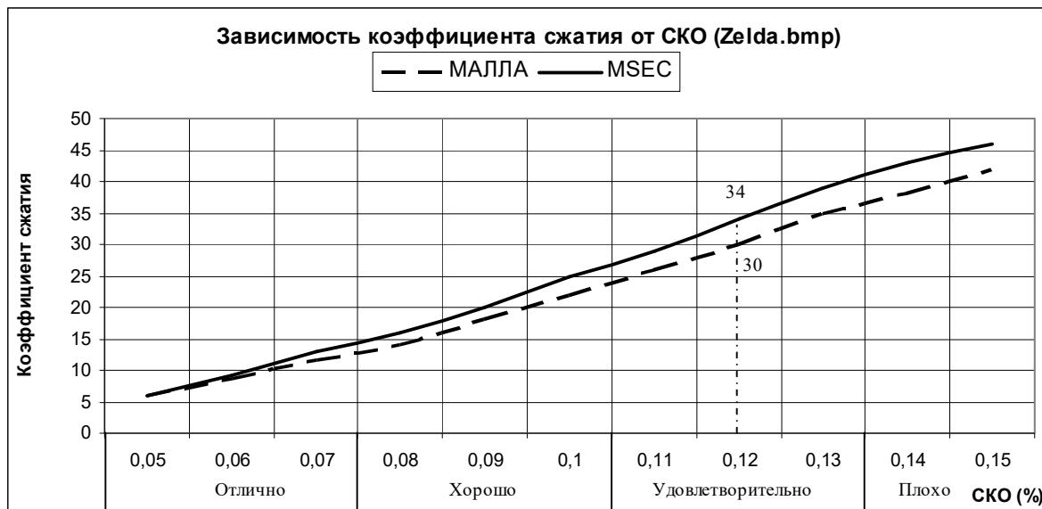
Рис. 6. Графіки залежності коефіцієнта стиснення K від середньо квадратичної похибки (СКП - E) тестового зображення Zelda.bmp.
