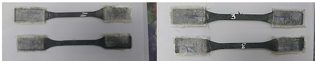
Рисунок 2. Образцы-лопатки для определения прочности при растяжении (после испытаний).
