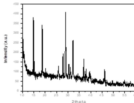
Fig. 1 XRD of  $V_2O_5$  - charcoal composite
