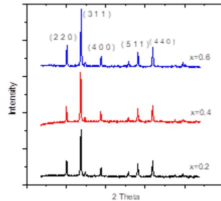
Fig: XRD of  $\text{Pb}_{1-x}\text{Co}_x\text{Fe}_2\text{O}_4$
