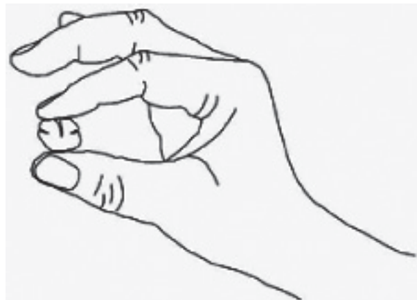
Figura 2. Determinación de la friabilidad del suelo de manera manual.
