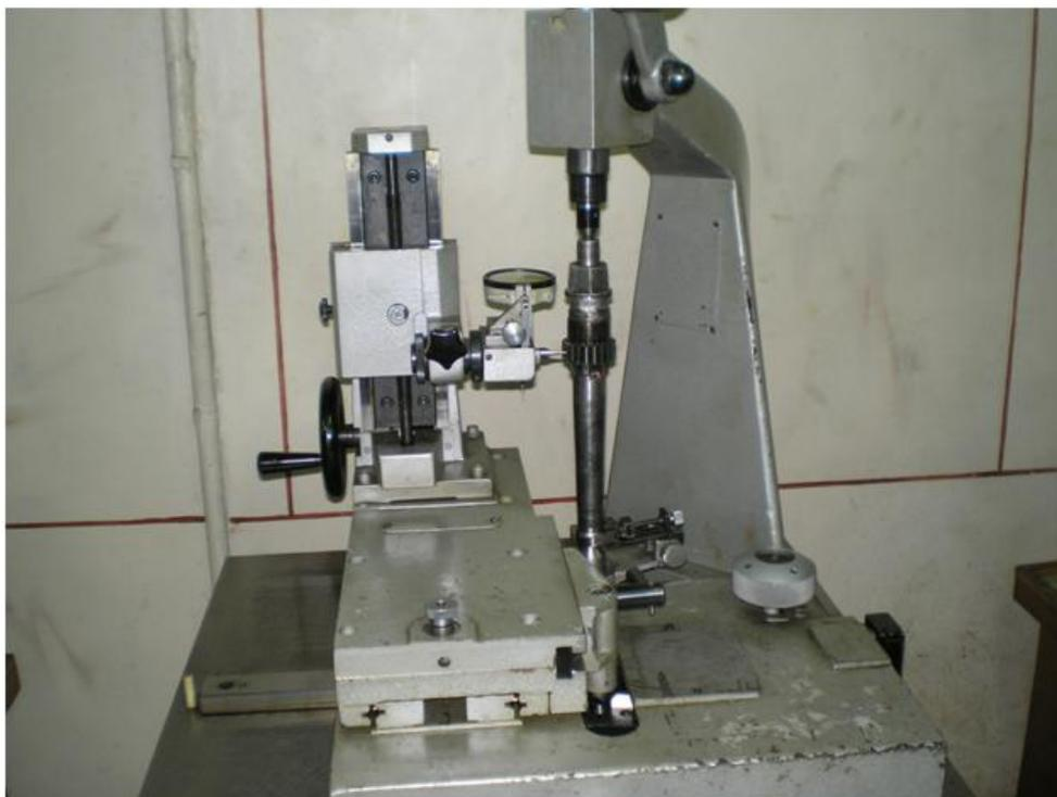
Рисунок 3 – Универсальный эвольвентомер КЭУ-М
