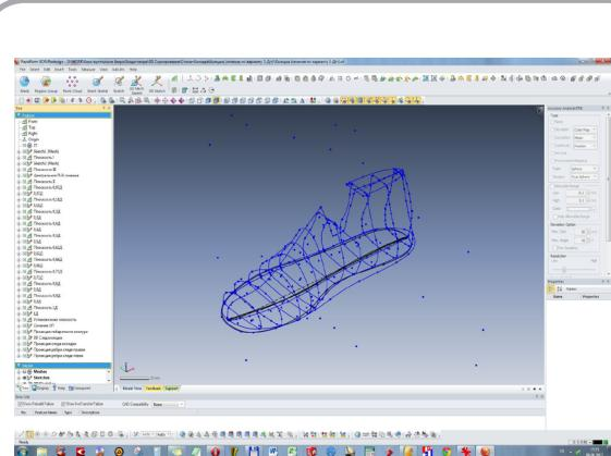
Рисунок 2 – Экранная форма полученных поперечно-вертикальных сечений колодки
