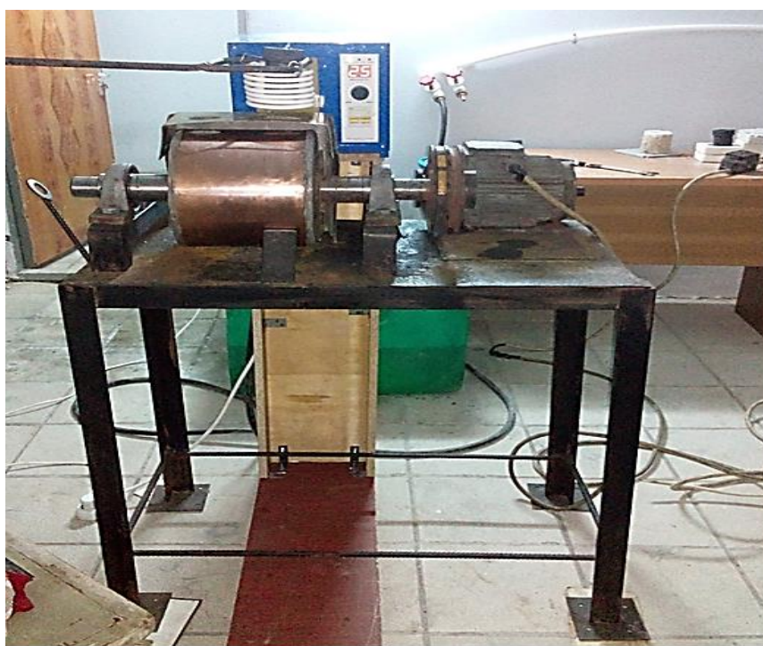
Рисунок 1. Установка для получения лент с аморфной структурой.
