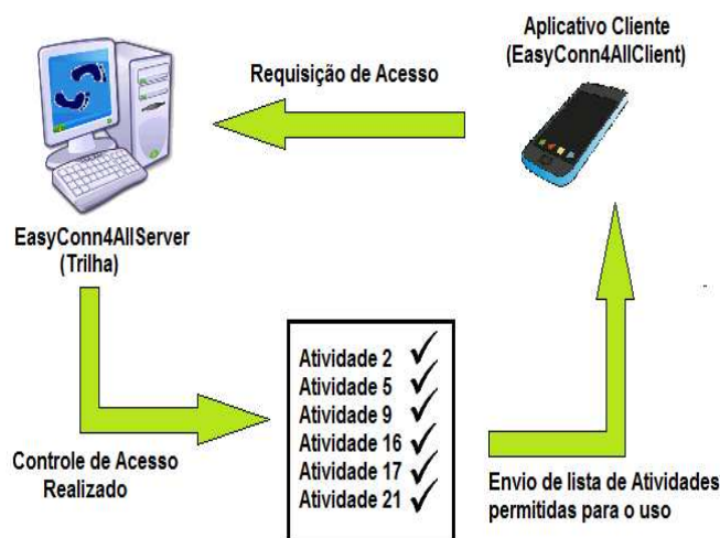
Fig. 5. Fluxo de informações entre servidor e cliente no controle de acesso.
