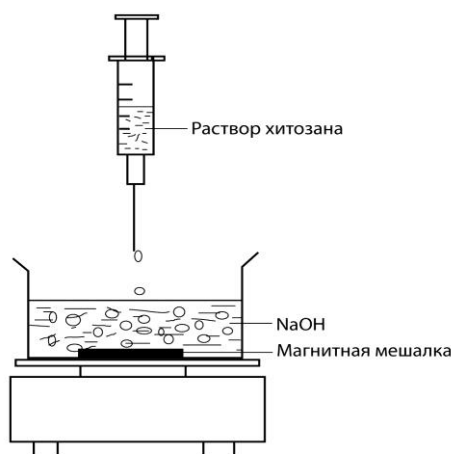
Рис. 2. Схема получения бус на основе хитозана и хитозана/гидроксилпатита
