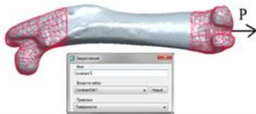
**Рис. 7.** Схема нагружения и закрепления кости при моделировании растяжения в программе Pro/Engineer. Зона красного цвета – область жесткого закрепления по всем степеням свободы (слева) и область приложения распределенной нагрузки Р (справа)
