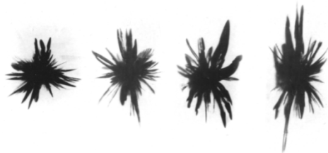
Рис. 2. Поперечный профиль разрушений в ПММ при давлениях (0, 10, 20, 30) МПа
