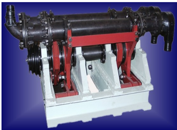
Рис. 1. Дезинтегратор производительностью 150 кг\час. Мельница шаровая центробежно-эллиптическая ЦЭМ-7
