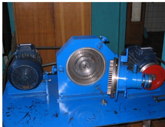
Рис. 1. Дезинтегратор производительностью 150 кг\час. Мельница шаровая центробежно-эллиптическая ЦЭМ-7
