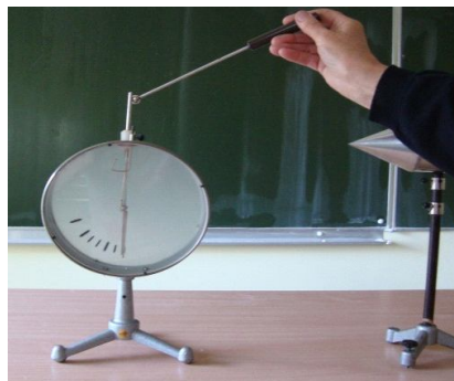
9 pav. Nuo vidinės dalies pernešamas krūvis ant elektrometro
