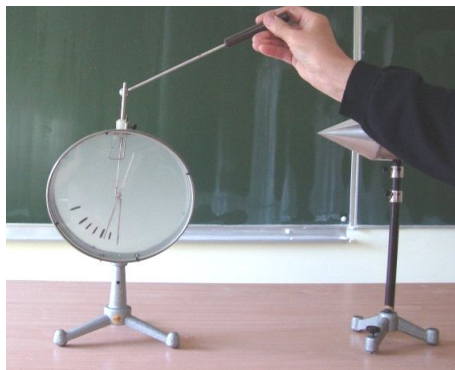
7 pav. Nuo lygiosios dalies pernešamas krūvis ant elektrometro
