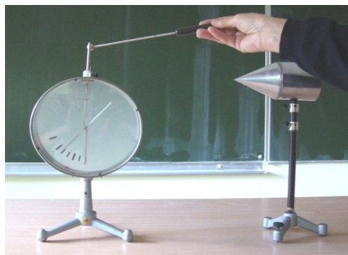
5 pav. Nuo smaigalio pernešamas krūvis ant elektrometro
