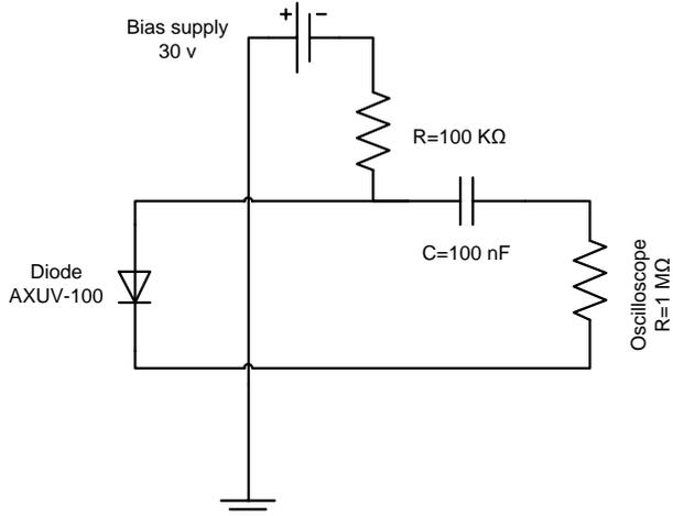
FIG. 4 SCHEME FOR BIASED OPERATION OF THE DIODE. THE DIODE IS CONNECTED TO A STORAGE OSCILLOSCOPE VIA A BIAS ELECTRONICS CIRCUIT.
