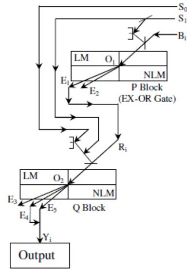
FIG. 8 ALL-OPTICAL TRUE/COMPLEMENT-ONE/ZERO CIRCUIT
